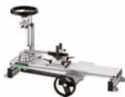
Механическое нагружающее устройство с переходным фланцем
